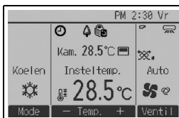
Hoofddisplay in de Volledig-modus op de hoofdafstandsbediening (wanneer het apparaat ingeschakeld is)
